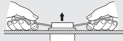
下図のような取外し治具が用意されています。ボタン取外し
